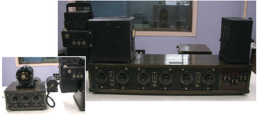
図-1 電磁オシログラフ (上智大学音声学研究室所蔵) 右: 信号記録部, 左: 電源・モータ
